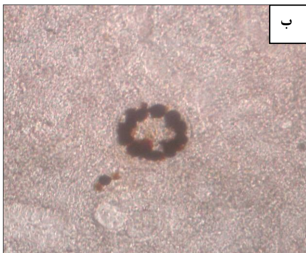
شکل ۱۳: الف) پیریت دانه تمشکی در کلسی‌اسفر، ب) نمای نزدیکتری از تصویر الف، پ) شکل‌گیری پیریت در حجره اجزای بیورژنیک (پیکان سفید روزن‌دار و پیکان سیاه کلسی‌اسفر).
