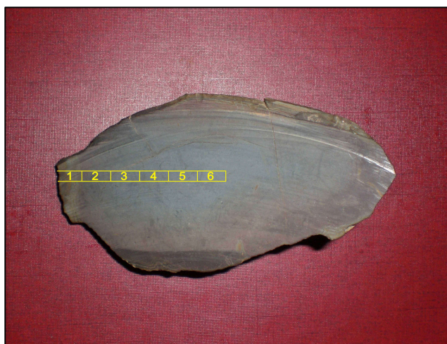
شکل ۴: نقاط نمونه‌برداری برای آنالیزهای کلسی‌متری و XRD از حاشیه به مرکز کنکرسایون.
