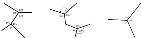
شکل ۵: نحوه اندازه‌گیری و نمایش زوایای بین ترک‌های متقاطع
